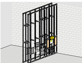
Jednostronne wykorzystanie ścianki działowej Viega Steptec.
